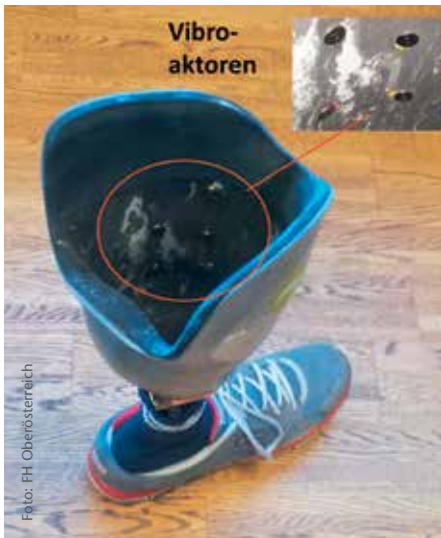
Abb. 7 Prothesenschaft mit integrierten Vibroaktoren.
