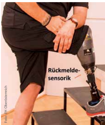
Abb. 8 Prothese mit miniaturisierter Rückmeldesensorik.
