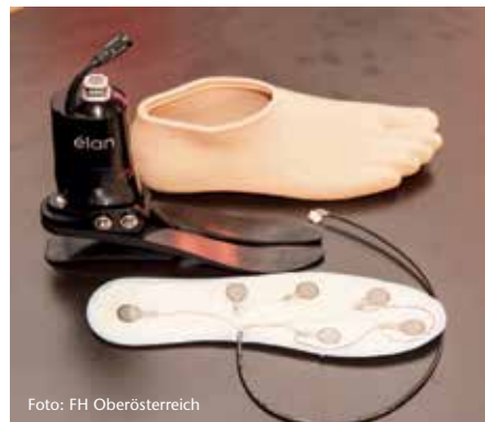
Abb. 5 Sensorsohle, bestehend aus sechs Sensoren zum Einlegen zwischen Prothesenschuh und Prothese.
